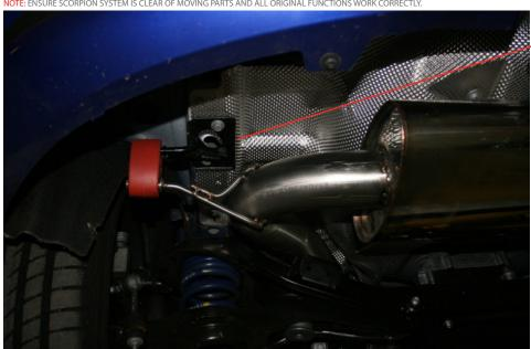
THE LEFT HAND SIDE REAR HANGER FOR THE REAR SILENCER NEEDS TO BE TAKEN OFF AND ROTATED 180° AND RE-FITTED AS SHOWN IN THE FITTING PICTURE. THEN YOU CAN START TO ASSEMBLE THE SCORPION SYSTEM.
